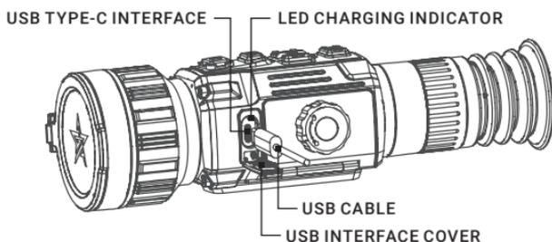
FIGURE 2-4. CONNECTING THE DEVICE
